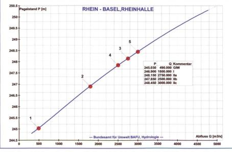
Bild 2. Pegel-Abfluss Beziehung für Basel, Rheinhalle mit GIW, HW-Marke I und IIa, b, c, (Erklärung siehe folgender Text und Tabelle).
