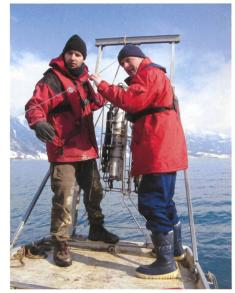
Bild 1. Die Analyse der vielfältigen Zusammenhänge und Wechselwirkungen im Seeökosystem erforderte aufwändige wissenschaftliche Untersuchungen. Mit modernsten Messgeräten, welche bis auf den Seegrund abgesenkt wurden (Bild), erhielten die Forscher Auskunft über die Temperaturschichtung des Wasser, die Trübung und den Sauerstoff in verschiedenen Wassertiefen.
