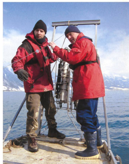
Bild 1. Die Analyse der vielfältigen Zusammenhänge und Wechselwirkungen im Seeökosystem erforderte aufwändige wissenschaftliche Untersuchungen. Mit modernsten Messgeräten, welche bis auf den Seegrund abgesenkt wurden (Bild), erhielten die Forscher Auskunft über die Temperaturschichtung des Wasser, die Trübung und den Sauerstoff in verschiedenen Wassertiefen.
