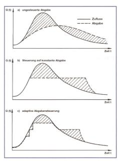
Bild 7. Steuerung der Beckenabgaben.
