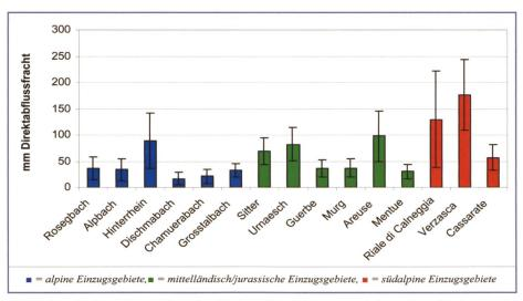
Bild 2. Gemittelte grösste jährliche Direktabflussfrachten und deren Standardabweichungen [mm] der untersuchten Einzugsgebiete.
