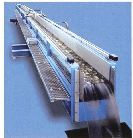
Bild 4. Modellrinne im Versuch: Im Bild zu sehen ist auch das Positioniersystem, an dem Laser (zur Bestimmung der Sohlentopographie) und Ultraschall (zur Aufnahme des Wasserspiegels) angebracht sind.
