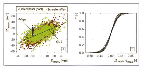
Bild 8a. Korrelation in der Meso-Skala zwischen der Rauigkeitshöhe  $Z_{meso}$  und der Sohleneintiefung d $Z_{meso}$  am Beispiel eines Versuches mit 13% Rinnengefälle, b) Summenhäufigkeit p\* der Residuen d $Z_{resi}$  aller Versuche bezogen auf den maximalen Korndurchmesser d $_{max}$  d $Z_{resi}$  ist dabei die Reststreuung der Eintiefung, die nicht auf die beschriebenen Skaleneffekte zurückgeführt werden kann.
