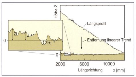
Bild 3. Bestimmung der Standardabweichung der Rauigkeitserhebungen mit vorgehender Entfernung des linearen Trends.
