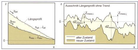
Bild 7. Definitionsskizze der für die Gleichungen (4)-(7) massgebenden Grössen.
