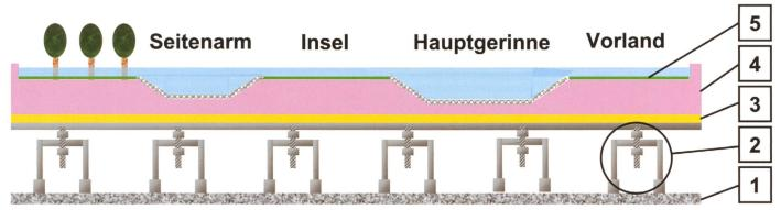
Bild 4. Schemaskizze des innovativen Modellbaukonzeptes (Grundplatte [1], Unterkonstruktion [2], Schaltafel [3], Polystyrol-Extruderschaumstoff [4], Grundrauigkeit [5]).
