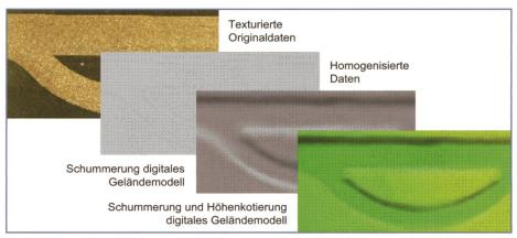
Bild 9. Bearbeitungsschritte von terrestrischen Laserscan-Daten.
