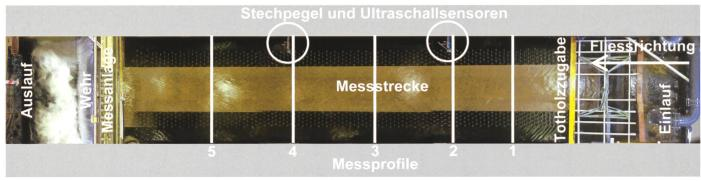
Bild 6. Anordnung der Einrichtungen der Messtechnik.
