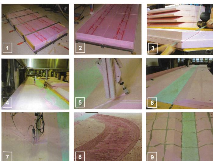
Bild 5. Fotodokumentation der Bearbeitung der Polystyrol-Extruderschaumstoffplatten (Verkleben von jeweils vier Einzelplatten [1], Planfräsen der Unterseite [2], grobes Vorschneiden [3], Montage der Platten und Planfräsen der Oberseite [4], schräg gestellter Fräser bei der Bearbeitung der Böschung des Hauptgerinnes [5], modelliertes Hauptgerinne [6], Fräsen des Seitenarmes [7], gefräster Seitenarm [8], bearbeitete Oberfläche mit abgedichteten Fugen [9]).
