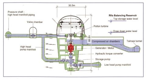
Bild 1. Querschnitt durch die Kaverne des Kopswerk II [1].
