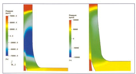
Bild 8. Statische Druckverteilung im Injektor (Überdruck).
