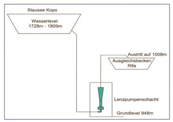
Bild 3. Anlagenschema mit geodätischen Höhen.
