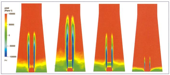
Bild 9. Zeitlich veränderliche statische Druckverteilungen im Bereich der Strahl-Scherschichten simuliert mit dem SAS-Modell (rot  $\leq$  1bar, blau = -1bar).
