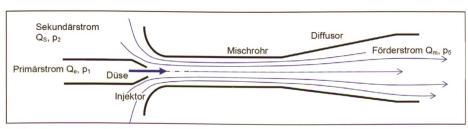
Bild 2. Schematische Darstellung der Elemente einer Strahlpumpe.
