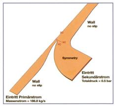
Bild 7. Randbedingungen der numerischen Strömungsberechnung.
