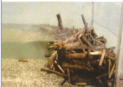
Bild 1. Systematische Untersuchungen zu Netzsperrern: links Modellversuch, rechts Naturversuch.
