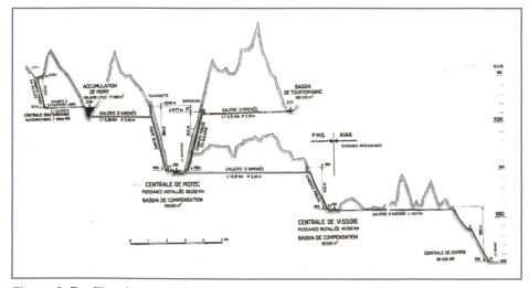
Figure 2. Profil en long schématique de l'aménagements des Forces Motrices de la Gougra (source: FMG).
