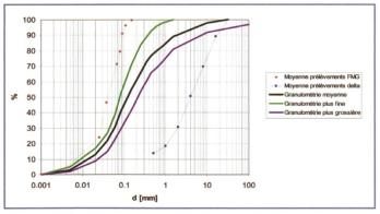
Figure 16. Courbes granulométriques utilisées pour le calcul de l'efficacité du dessableur.
