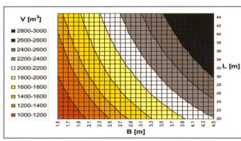
Figure 15. Volume dessablé annuellement à Tourtemagne en fonction des dimensions d'un dessableur de hauteur h= 3,5 m.
