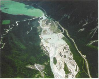
Bild 7. Wurzel des Speichers Sylvenstein mit einem Geschiebesammler im Hauptzufluss.
