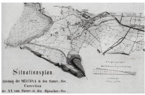
Bild 1. Melchaa- und Sarneraa-Korrektion. Situationsplan 1:5000 (Ausschnitt), mit Längsprofil und Normalprofil, wohl von Ingenieur Caspar Diethelm in den 1870er Jahren gezeichnet und vielleicht die einzige Plangrundlage für die Ausführung (Foto D. Reinhard, Sachseln).
