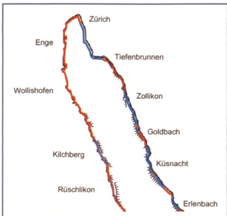
Bild 9. Kartenausschnitt aus der geologischen Eignungskarte. Auf den rot eingezeichneten Uferabschnitten ist der Untergrund problematisch: Dort findet man Rutschungen, unverbundene Schlämme oder Seekreide. Auf den blauen Strecken ist der Untergrund vermutlich fest. Wo vorhanden, ist auch die Böschungskante unter Wasser eingezeichnet.
