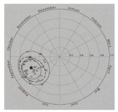
Bild 5. Illustration der «Quantilsellipsen» (90%, 75% und 50%) zur Umschreibung der zu einem Regimetyp gehörenden Stationen: Beispiel Niederwassersaisonalität für den Regimetyp 10 (pluvial inférieur). Die 90%-Ellipse ist punktiert, die 75%-Ellipse gestrichelt und die 50%-Ellipse durchgezogen eingetragen.
