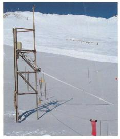
Bild 2. Installation des Snowpower-Sensors auf dem Weissfluhioch Davos.
