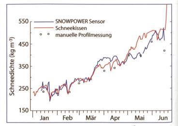
Bild 6. Saisonaler Verlauf der Schneedichte (kg/m³) im Winter 2004/05 auf dem Weissfluhjoch gemessen mit dem Snowpower-Sensor, dem Schneekissen und aus manuellen Profilmessungen.
