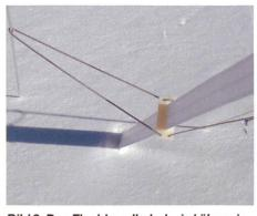
Bild 3. Das Flachbandkabel wird über ein Gummiband und 2 parallel verlaufende Nylonschnüre seitwärts stabilisiert.
