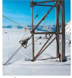
Bild 4. Über eine gefederte Aufhängung wird das Flachband an einem Mast befestigt.
