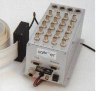
Bild 1. Bestandteile des Snowpower-Sensors: (a) Querschnitt des Flachbandkabels, (b) Elektronische Messeinheit, bestehend aus einem Multiplexer, einem Impedanzmessgerät und einem Datenspeicher.
