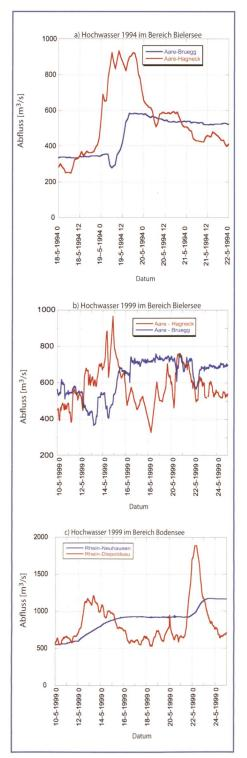
Bild 9. Zu- und Ausflüsse des Bielersees und des Bodensees bei den Hochwassern 1994 und 1999.
