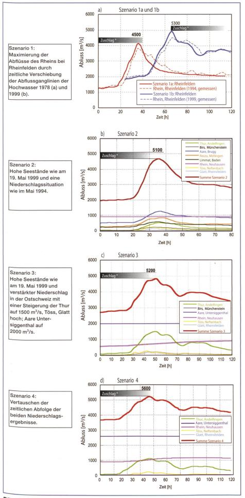
Bild 10a–d. Die Szenarien 1–4: Die Summe entspricht Rheinfelden, der graue Balken markiert den Zuschlag von Ergolz, Wiese und des nicht berücksichtigten Resteinzugsgebiets.
