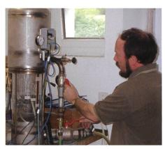
Bild 4. Bruno Schindelholz von der stiftung revita testet das Funktionsmuster einer Turbinenanlage für geschlossene Trinkwasserversorgungssysteme. (Bilder: stiftung revita)
