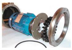
Bild 3. Peltonturbine und Generator in der Übersicht.
