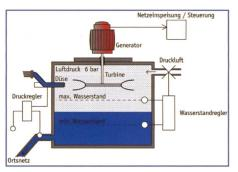
Bild 2. Eine Peltonturbine dreht in einem Luftpolster, das zur Aufrechterhaltung des Leitungsdrucks im Trinkwassersystem dient.
