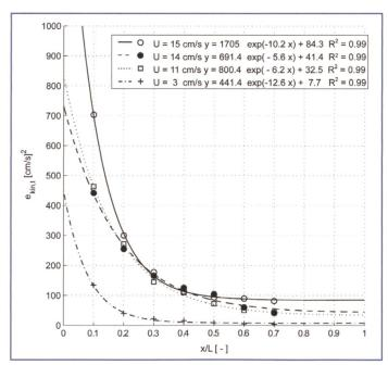
Bild 10. Darstellung der exponentiellen Abnahme der turbulenten kinetischen Energie e<sub>kin,</sub>t über die normierte Beckenlänge x/L am Entsander Schweiben, für 4 verschiedene mittlere Fliessgeschwindigkeiten U.
