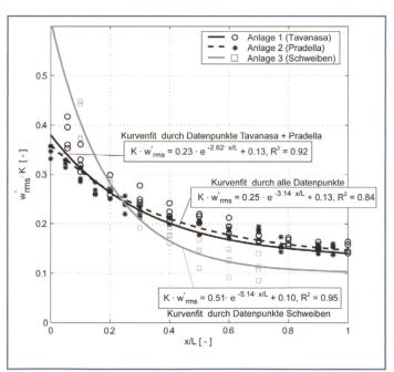
Bild 11. Darstellung der normierten vertikalen Turbulenzintensität w'<sub>rms</sub> K über die relative Beckenlänge x/L. Die Normierungsparameter sind: U (U<sub>E</sub>): Strömungsgeschwindigkeit im Sandfang (im Zulaufkanal), m: Neigung des vertikalen Übergangs vom Zulaufkanal zur Entsandersohle, g: Erdbeschleunigung, R: hydraulischer Radius des Sandfanges.
