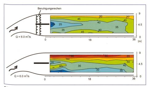
Bild 8. Mittlere Strömungsgeschwindigkeiten in [cm/s] im Entsander Tavanasa  $Q = 6 \, m^3/s$ ,  $U = 0.33 \, m/s$ . Durch den Einbau des zweireihigen Beruhigungsrechens Wird eine deutliche Vergleichmässigung der Strömung erreicht.
