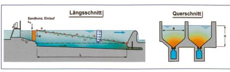
Bild 1. Längs- und Querschnitt durch einen Langsandfang.
