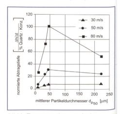
Bild 3. Zusammenhang zwischen mittlerem Partikeldurchmesser d<sub>p50</sub> und normierter Abtragstiefe (Verschleiss), für relative Geschwindigkeiten zwischen feststoffhaltigem Wasser und Probekörper von 30–80 m/s. Die Abtragstiefe ist mit dem Anteil harter Bestandteile (prozentualer Quarzanteil der Gesamtkonzentration) normiert, aus Keiser (1999).
