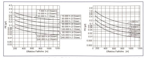
Bild 6. Reparaturzyklen der Becher (links) und der Düsen von Peltonturbinen (rechts) aus 13 Cr 4 Ni, nach Nozaki (1990).
