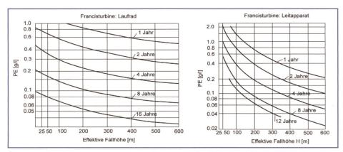
Bild 5. Reparaturzyklen der Laufräder (links) und des Leitapparates von Francisturbinen (rechts) aus 13 Cr 4 Ni, nach Nozaki (1990).
