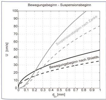
Bild 12. Mittlere Strömungsgeschwindigkeit U in Sandfängen, die in Abhängigkeit des Grenzkorndurchmessers d<sub>Gr</sub> eingehalten werden muss, um Bewegungsbeginn bzw. Suspensionsbeginn zu vermeiden. Die gestrichelten Linien stellen eine untere, die durchgezogenen eine obere Grenze dar.
