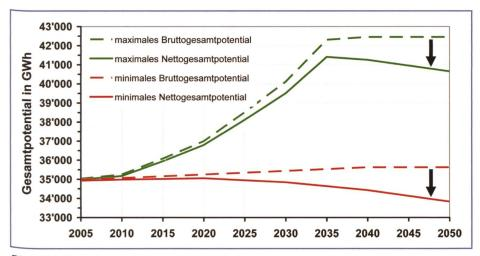
Bild 6. Einfluss der Restwasservorschrift.
