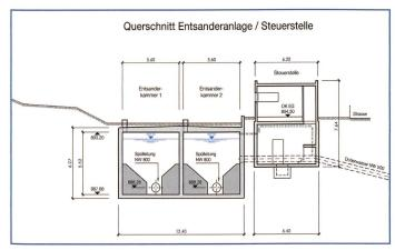
Bild 5. Querschnitt durch Entsander und Steuerstelle.
