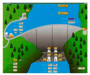
Figure 5. Exemple d'une image du système de conduite: le barrage de Rossens.
