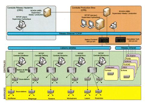
Figure 3. Vue d'ensemble du système de conduite.
