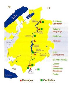
Figure 1. Aménagements hydroélectriques des EEF.
