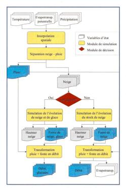
Figure 1. La structure du modèle hydrologique.
