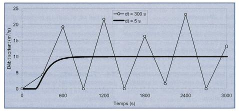
Figure 2. Exemple d'instabilité numérique dans un calcul de rétention. La retenue, initialement vide, présente une surface de 1000 m². Le débit entrant est constant et vaut 10 m³/s. La retenue est équipée d'un déversoir standard de 2 m de largeur et dont le seuil se situe à la cote de 2 m.
