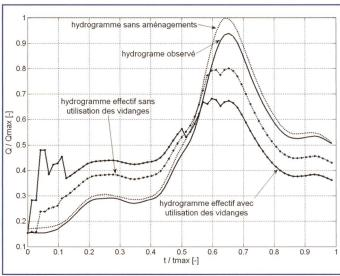
Figure 4. Influence des aménagements hydroélectriques et effet des opérations préventives (turbinage seul ou combiné avec vidanges) lors de la crue 1993 à Lavey.
