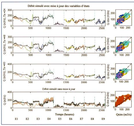
Figure 6. Débits horaires observés (courbe noire) et prévus (courbes en couleur) pour différents temps d'anticipation. Résultats du modèle de prévision à Brigue. De haut en bas: résultats avec MAJ des v.e. (temps d'anticipation de 24, 48 et 60 heures); en bas: débit simulés sans MAJ des v.e. Graphiques de gauche: évolution temporelle des débits pour les 9 événements sélectionnés. Graphiques de droite: débits observés fonction des débits prévus.
