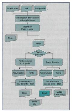
Figure 2. Schéma de principe du modèle hydrologique.
