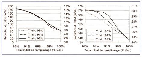
Figure 4. Etude de sensibilité du taux initial de remplissage des retenues et du taux d'enclenchement Tmin du turbinage. a) Branson, b) Viège.
