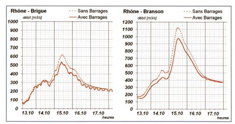
Figure 6. Hydrogrammes modélisés de la crue d'octobre 2000, aux stations limnimétriques du Rhône à Brique et Branson, avec et sans la présence des barrages.
