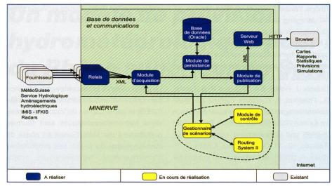
Figure 7. Architecture du système de communications de Minerve.
