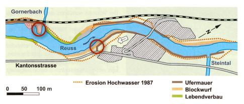
Bild 5. Übersicht des Hochwasserschutzprojekts Gurtnellen. Betonelemente sind an den beiden mit Kreisen markierten Stellen eingesetzt.
