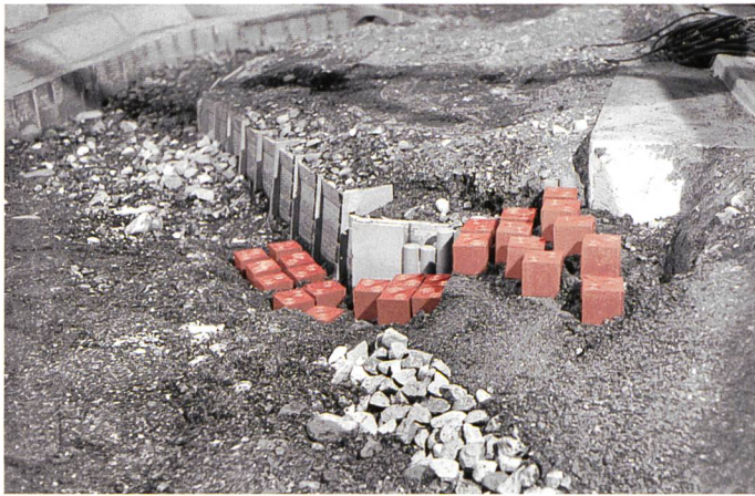
Bild 6. Flussaufwärtiges Ende der rechten Uferschutzmauer in Gurtneilen beim Einbau der Prismen im hydraulischen Modell. Die in der Flusssohle und der Böschung vergrabenen Elemente schützen die Mauer vor Unterkolkung (Blick in Fliessrichtung).
