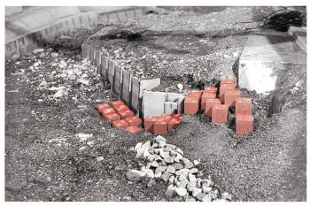
Bild 6. Flussaufwärtiges Ende der rechten Uferschutzmauer in Gurtnellen beim Einbau der Prismen im hydraulischen Modell. Die in der Flusssohle und der Böschung vergrabenen Elemente schützen die Mauer vor Unterkolkung (Blick in Fliessrichtung).
