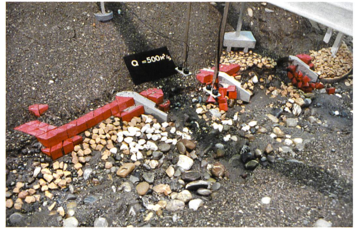
Bild 7. Bei der Nationalstrassenbrücke Wassen sind die drei bühnenförmigen Betonscheiben, welche die Strömung vom linken Ufer abweisen durch Betonprismen vor Hinterspülung geschützt. Zustand im hydraulischen Modell nach einem Abfluss von 500 \text{ m}^3/\text{s} (Fliessrichtung von links nach rechts).
