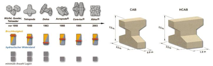
Bild 1. Entwicklung der im Küstenschutz als Wellenbrecher eingesetzten Betonelemente, dargestellt anhand der wichtigsten Formen (weitere Erläuterungen im Text).
