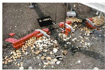
Bild 7. Bei der Nationalstrassenbrücke Wassen sind die drei buhnenförmigen Betonscheiben, welche die Strömung vom linken Ufer abweisen durch Betonprismen vor Hinterspülung geschützt. Zustand im hydraulischen Modell nach einem Abfluss von 500 m³/s (Fliessrichtung von links nach rechts).
