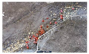
Bild 12. Flussaufwärtiges Ende der rechten Uferschutzmauer im hydraulischen Modell Gurtnellen nach der Simulation eines Extremereignisses mit einem Abfluss von 1000 m³/s. Rund ¼ der zum Schutz der Mauer versetzten Prismen wurde abtransportiert (Fliessrichtung von links nach rechts).
