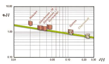
Bild 13. Maximaler dimensionsloser spezifischer Abfluss q, in Abhängigkeit des Längsgefälles J für die im Modell untersuchten Hochwasserschutzprojekte. Die untere Umhüllende der Datenpunkte entspricht Gleichung (5).
