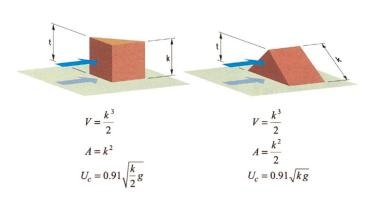
Bild 10. Ungünstige Lage (links) und günstige Lage (rechts) eines Prismas mit Kantenlänge k zur Berechnung der kritischen Fliessgeschwindigkeit bei Bewegungsbeginn.
