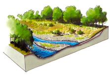
Bild 5. typisches Querprofil im aufgeweiteten Bereich (projektierter Endzustand).
