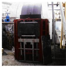
Figure 13. Volume plongeur installé sur le bassin amont.
