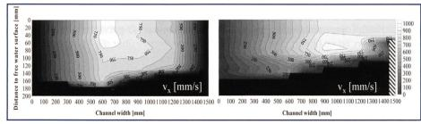
Bild 4. Linien gleicher Geschwindigkeit (Isotachen) in Kanalachse oberstrom (links) und im Bereich des Überfalls (rechts).
