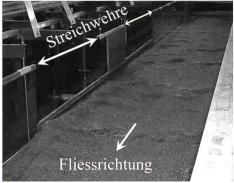
Bild 1. Versuchsstand mit Hauptgerinne und beweglicher Sohle, Streichwehr(en) und Seitenkanal zur Ableitung des über das Wehr abgegebenen Abflusses.
