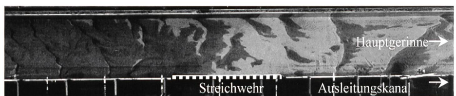
Bild 2. Sohlenmorphologie nach Beendigung der Versuchsreihe B02.
