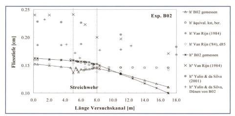
Bild 3. Vergleich gemessener und berechneter Fliesstiefen. h' steht für kornbezogene bzw. Anfangswassertiefen, h" für auf den Gesamtwiderstand bezogene bzw. dünenbeeinflusste Wassertiefen nach fortgeschrittener Versuchsdauer.
