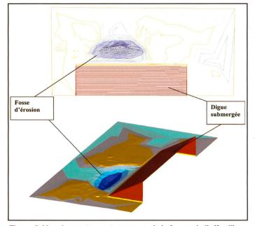
Figure 3. Vue du revetement rugueux, de la forme de l'affouillement en pied de digue submergée avec une représentation 3D.
