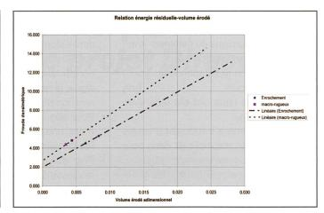
Figure 9. Relation entre l'énergie résiduelle et le volume érodé avec une granulométrie de la fosse d'érosionde 0/16.
