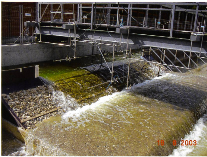
Figure 4. Essais sur revêtements rugueux, macro-rugueux et enrochement (Rip-Rap) avec représentation en 3D de l'affouillement pour une hauteur de déversement de 7 cm.
