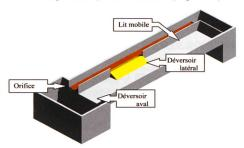
Figure 1. Schéma du canal d'essais.
