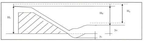
Figure 8. Schéma de l'affouillement en pied de digue.
