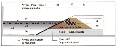
Figure 6. Coupe transversale du couronnement fusible sur le modèle à écoulement longitudinal.
