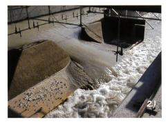
Figure 8. 1) Ouverture de la brèche 2) Allongement de l'ouverture.
