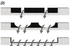
Figure 1. Fonction hauteur/débit modifiée par le déversement (1). Scénario d'ouverture (2).
