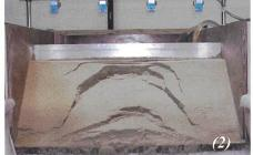
Figure 5. Essai 4 (vue d'aval): confection de la gaine (1), ouverture de la brèche (2).
