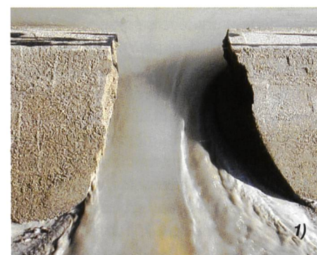
Figure 7. Isométrie du couronnement fusible dans le modèle à écoulement longitudinal.
