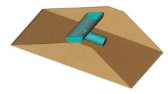
Figure 10. Représentation tubulaire du dispositif fusible.
