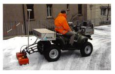
Bild 1. Quad mit GPS, Georadar und zwei roten 400-MHz-Antennen.
