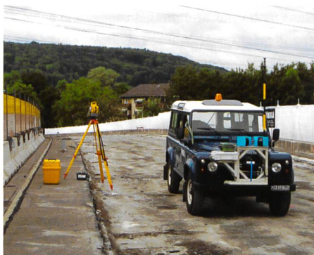
Bild 4. Landrover mit Laserscannern.
