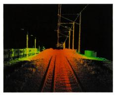
Bild 3. Laserscann, gemessen dynamisch mit dem Swisstrolley.
