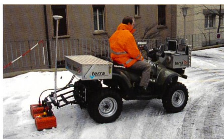
Bild 1. Quad mit GPS, Georadar und zwei roten 400-MHz-Antennen.
