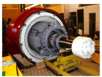
Bild 5. Generatorrotor mit neuem Erregerrotor mit rotierenden Dioden.
