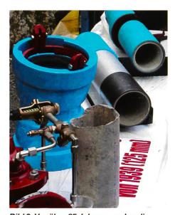
Bild 2. Vor über 65 Jahren wurden die Trinkwasserleitungen aus Eternit (Vordergrund) erstellt. 2004 erfolgte der Bau der Ersatzdruckleitung, die aus beschichteten Gussrohren besteht.
