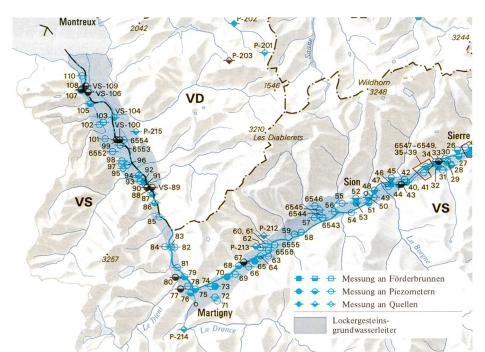
Bild 6. Karte der Grundwassermessstellen (nach: HADES-Tafel 8.5).
