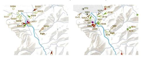
Bild 7. Messnetze zur Beobachtung chemischer und physikalischer Parameter mit verschiedenen Typen von Messstellen; links: Stand 1989, rechts: Stand 2002 (nach: HADES-Tafeln 7.1 und 7.12).
