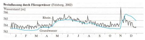
Bild 5. Beeinflussung des Grundwasserstandes durch Fliessgewässer (nach: HADES-Tafel 8.5).
