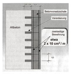
Bild 1. Verankerte Vorsatzschale aus Stahlbeton (DIN 1045 und [1]) aus wasserundurchlässigem und frostbeständigem Beton (Zementgehalt 300...350 kg CEM I/m³ FB), wobei die oberflächennahe Bewehrungslage doppelt so stark wie die rückwärtige Lage zur Verringerung der Rissbildung sein soll.
