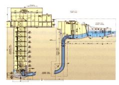
Längsschnitt durch Schacht und Auslaufbauwerk.
