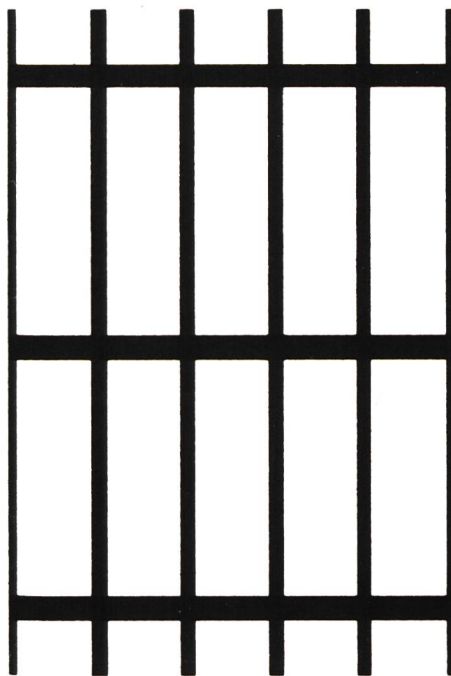
Bild 4. Definitionsskizze Verbauung: P = Gesamtfläche der Stäbe plus aller konstruktiven Elemente dividiert durch die Bruttofläche des Rechenfeldes.
