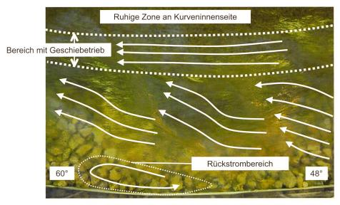
Bild 9. Strömungsverhältnisse mit der Geometrie der optimierten Ausbuchtungen des Blockwurfes mit variabler Neigung (Q = 100 l/s, Lage zwischen 48° und 60° in Kurve).
