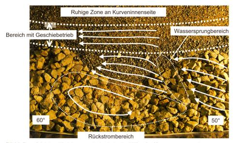
Bild 6. Draufsicht auf Sohlenmorphologie in der Nähe der Kurvenaussenseite (stationärer Zustand nach Q = 100 I/s, Lage zwischen 50° und 60° in Kurve).
