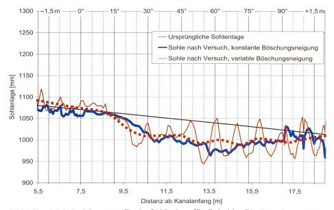
Bild 7. Vergleich der Längenprofile der Sohlenlage für die beiden Blockwurfgeometrien ( $R=6100\,\mathrm{mm},\,Q=100\,\mathrm{l/s}$ ). Die rot gestrichelte Linie entspricht der mittleren Sohlenlage für den Blockwurf mit variabler Neigung.
