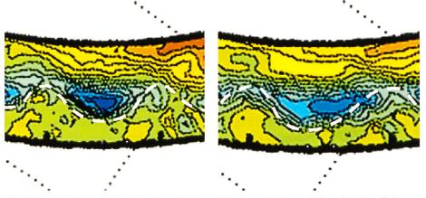
Bild 10. Lokale Kolke in den Buchten für einen Blockwurf mit geschlängelter Fusslinie. Links: Ausbuchtungen mit konstanter Neigung. Rechts: Optimierte Ausbuchtung mit reduzierter Neigung (vgl. Bild 8). Die gestrichelte Linie markiert den Fuss des Blockwurfes.
