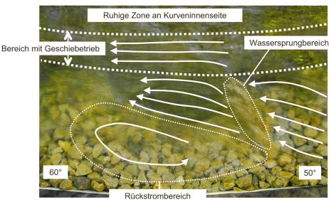
Bild 5. Draufsicht auf Strömung in der Nähe der Kurvenaussenseite (Q = 100 I/s, Lage zwischen 50° und 60° in Kurve).
