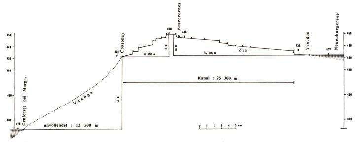
Bild 2. Überhöhtes Längsprofil des Canal d'Entreroches. Von der 37,8 km langen Strecke wurden 25,3 km erstellt und längere Zeit betrieben.
