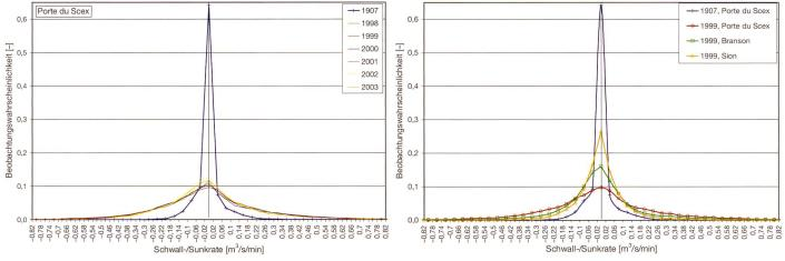
Bild 12. Jährliche Beobachtungswahrscheinlichkeiten der Schwall- und Sunkraten. Links: Porte du Scex 1907 und 1998–2003. Rechts: Porte du Scex 1907 und Porte du Scex, Branson, Sion 1999.
