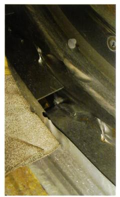
Bild 11. Sandschliffschäden an Leitschaufeln und Schutzring.
