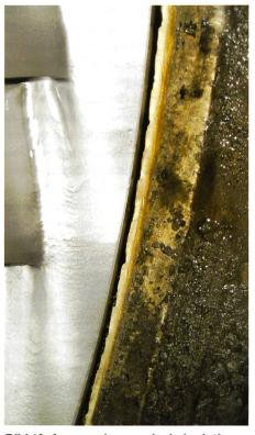
Bild 10. Auswaschungen im Labyrinthspalt.
