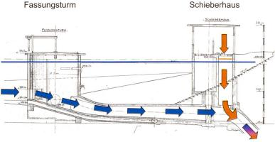
Bild 7. Einleitung Baggergut beim Schieberhaus.
