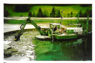
Bild 6. BKW-Schwimmbagger im Einsatz.
