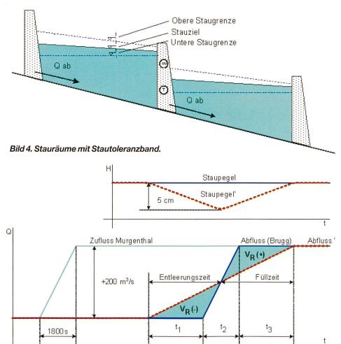
Bild 5. Gedämpfte Übertragungsfunktion am Beispiel «Untere Aare».
