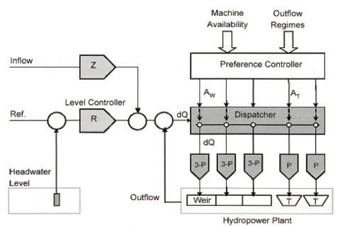
Bild 1. Wasserhaushaltsautomatik einer Staustufe.
