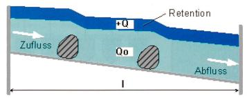
Bild 3a. Retentionsvolumen einer geregelten Staustufe.
