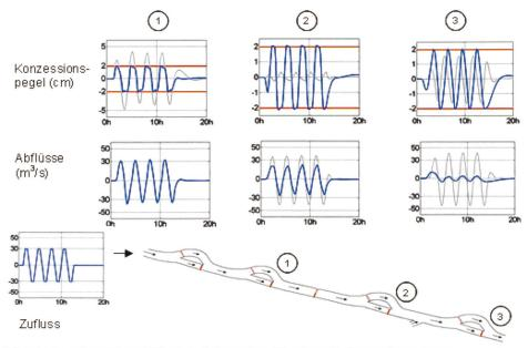
Bild 8b. Pegel und Durchflüsse bei einer sinusförmigen Zuflussschwankung (hell: lokale PI-Regler, dunkel: MPC).
