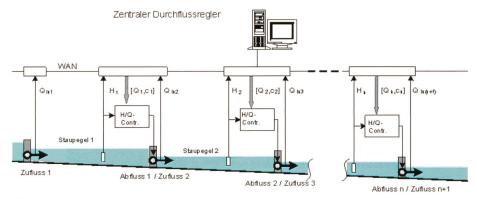
Bild 7. Regeleinrichtung für Staustufenketten.
