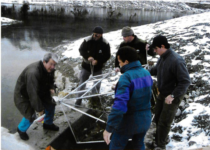
Bild 9. Wo innerhalb des Projektperimeters keine natürliche Gewässervernetzung möglich war, sorgte der Baubegleiter – zusammen mit der kantonalen Fischeaufsicht – zumindest für die Sicherung der Fischdurchgängigkeit. Links: Am Ausgang des Dükers unter dem Neuen Flaz wird eine Kontrollreuse geleert – der Düker ist trotz 75 m Länge uneingeschränkt fischgängig. Rechts: Über eine naturnah angelegte Passage können nun alle Fische vom Inn in die Gravatschaseen und von dort zurück wandern (Fotos: Meuli, Rey).
