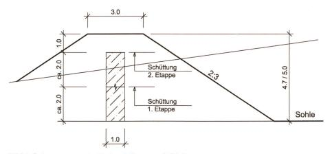
Bild 4. Schemaquerschnitt durch Damm mit Dichtungskern.
