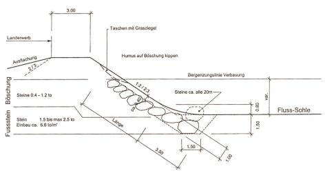
Bild 3. Querschnitt gesicherte Uferböschung.
