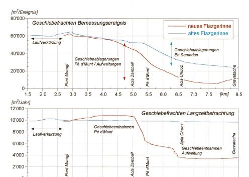
Bild 5. Transportierte Geschiebefrachten in Flaz und Inn mit und ohne Flazverlegung für das Bemessungsereignis  $HQ_{100}$  (oben) und die Langzeitbetrachtung (unten).
