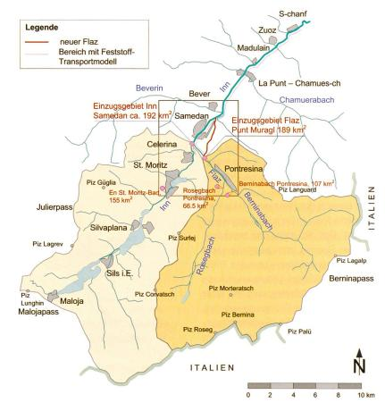
Bild 1. Einzugsgebiete von Inn und Flaz bei Samedan mit neuem Flazlauf (rot) und Bereich mit Feststofftransportmodell (Ausschnitt siehe Bild 3).
