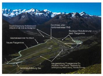
Bild 5. Flazverlegung – Fotomontage des neuen Flazgerinnes für den Hochwasserfall HQ<sub>100</sub>.
