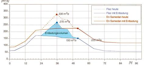
Bild 4. Abflussganglinie des Bemessungsereignisses HQ<sub>100</sub> für die Variante Flazentlastung mit dem notwendigen Entlastungsvolumen.
