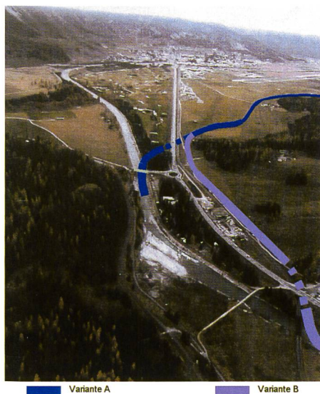
Bild 3. Variantenstudie für Gerinneanfang im Raum Punt Muragl – Variante A: gewählte Lösung beim Kreisel Punt Muragl; Variante B: Alternativvariante mit Gerinneanfang bei der Muottas-Muragl-Bahn.
