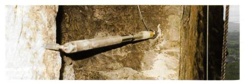
Bild 3. Messgerät zur Distanzmessung einer Kluft am Breitenberg in Vorarlberg.
