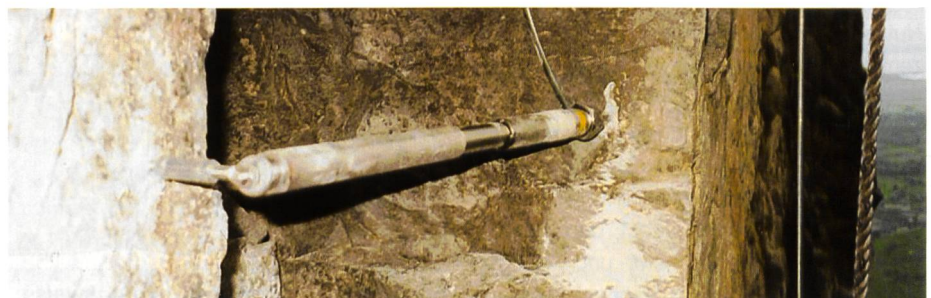
Bild 3. Messgerät zur Distanzmessung einer Kluft am Breitenberg in Vorarlberg.
