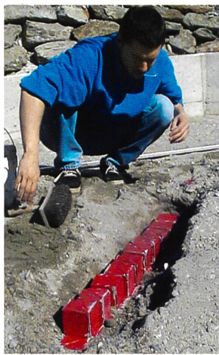
Bild 7. Einbau der Blockbuhnen im Modell (links); freigespülte Schutzbauten im Versuch 8 für 150 m 3 /s (rechts).
