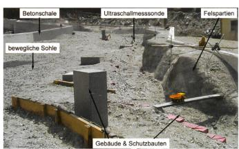
Bild 5. Hydraulisches Modell der Société Suisse des Explosifs mit Blickrichtung flussaufwärts.
