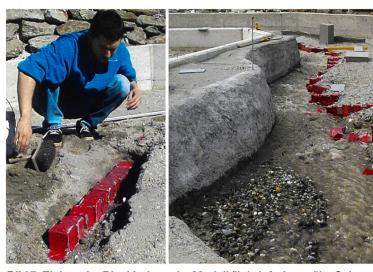
Bild 7. Einbau der Blockbuhnen im Modell (links); freigespülte Schutzbauten im Versuch 8 für 150 m³/s (rechts).
