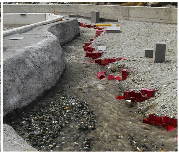
Bild 7. Einbau der Blockbuhnen im Modell (links); freigespülte Schutzbauten im Versuch 8 für 150 m 3 /s (rechts).
