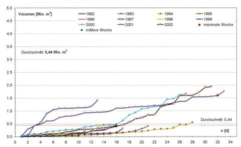
Bild 8. Anzahl Tage, an denen der Abfluss den Grenzabfluss nach AP 1 (130 m³/s) in den Jahren 1992 bis 2002 übersteigt (1. bis 8. Kalenderwoche), und zugehörige Volumen des den Grenzwert überschreitenden Abflusses (Werte nach Grösse sortiert).
