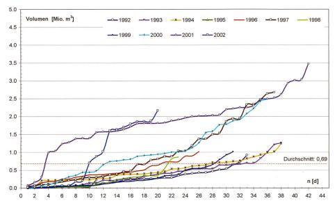
Bild 9. Anzahl Tage, an denen der Abfluss den Grenzabfluss nach AP 2 (115 m³/s) in den Jahren 1992 bis 2002 übersteigt (1. bis 8. Kalenderwoche), und zugehörige Volumen des den Grenzwert überschreitenden Abflusses (Werte nach Grösse sortiert).
