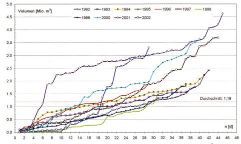
Bild 10. Anzahl Tage, an denen der Abfluss den Grenzabfluss nach AP 3 (95 m³/s) in den Jahren 1992 bis 2002 übersteigt (1. bis 8. Kalenderwoche), und zugehörige Volumen des den Grenzwert überschreitenden Abflusses (Werte nach Grösse sortiert).
