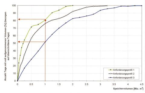
Bild 11. Anteil Tage (1. bis 8. Woche) [%] mit voll ausgeglichenem Volumen in Abhängigkeit des Rückregulierungsvolumens und des Anforderungsprofils.
