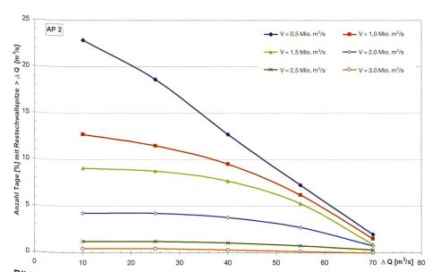
Bild 13. Häufigkeit [%] von Restschwallspitzen in Abhängigkeit ihrer Grösse und des Rückregulierungsvolumens für Anforderungsprofil 2.
