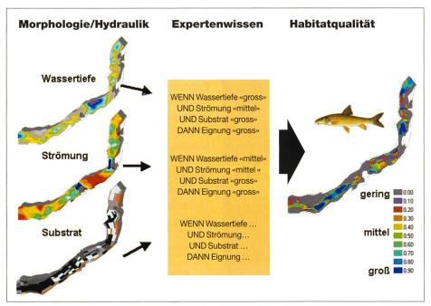
Bild 1. Prinzipielle Funktionsweise des Fisch-Habitatmodells im Modellsystem CASiMiR.
