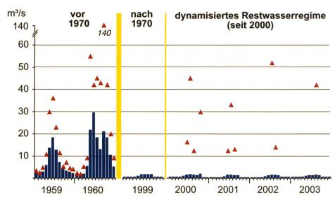
Bild 2. Abflüsse im Spöl (Hydrologische Station Punt dal Gall): vor Staumauerbau (vor 1970); konstantes Restwasserregime (1970–1999); dynamisiertes Restwasserregime (seit 2000).
