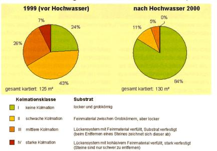
Bild 3. Reduzierung der Sohlkolmation.
